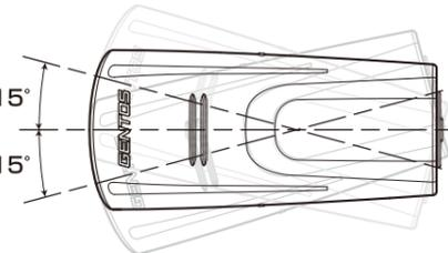
照射方向を水平に無段階(左15°・正面・右15°)に調節できます。
