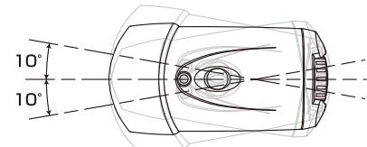
本体の照射方向を水平に3段階(左10°・正面・右10°)に調節できます。
