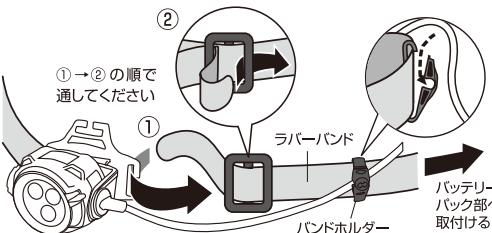
ラバーバンドの反対端を同様の手順でバッテリーパック部に取付けてください。
