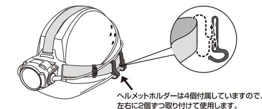
ヘルメットホルダーは4個付属していますので、左右に2個ずつ取り付けて使用します。
