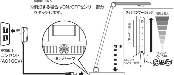
※LED消灯後もON/OFFセンサー部分は赤く点灯します。
