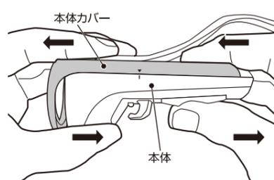
※本体カバーの脱着は必ず水平方向にスライドさせてください。
